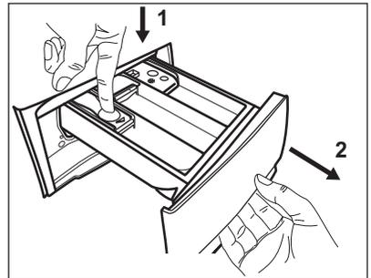
2. Lai atvieglotu tīrīšanu, noņemiet papildpiedevu nodaļuma augšdaļu un izskalojiet to zem tekoša silta ūdens, likvidējot visas uzkrātā mazgāšanas līdzekļa atliekas. Pēc tīrīšanas uzstādiat detaļu atpakaļ.
