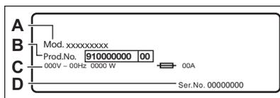
**Tehnisko datu plāksnītē** norādīts modeļa nosaukums (A), produkta numurs (B), elektriskie parametri (C) un sērijas numurs (D).
