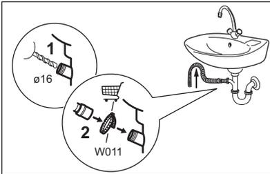
Pievienojiet ūdens novadīšanas šļūteni sifonam un nostipriniet to ar skavu. Pārliecinieties, ka ūdens novadīšanas šļūtene veido cilpu, lai neļautu netīrumiem no ierīces nokļūt izlietnē.
