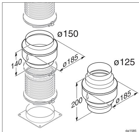
Kopā ar gaisa novadīšanas kanāla izlāciju ir ieteicams uzstādīt arī ūdens kondensāta barjeru, kas uztver un iztvaicē ūdens kondensātu.
