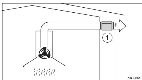
Gaisa novadīšanas režīmā trokšņa slāpētājs slāpē gan ventilatora trokšņus, gan arī skaņas (piemēram, ielas troksni), kas pa gaisa novadīšanas kanālu ieklūst virtuvē. Tāpēc trokšņa slāpētājs ir jānovieto pēc iespējas tuvāk gaisa novadīšanas izejai ①.
