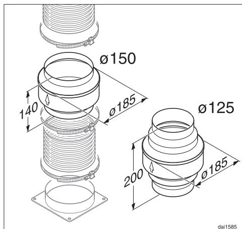
Kopā ar gaisa novadīšanas kanāla izlāiciju ir ieteicams uzstādīt arī ūdens kondensāta barjeru, kas uztver un iztvaicē ūdens kondensātu.
