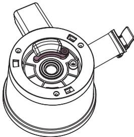
3. Uzlieciet spiešanas tvertni uz motora pamatnes, savienojiet bultiņu ar atbloķēšanas simbolu uz motora pamatnes. Pagrieziet tvertni tā, lai bultiņa savienojas ar bloķēšanas simbolu uz motora pamatnes.
