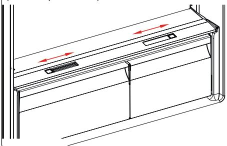
Ja dārzeņu nodalījums ir pilns, jāatver svaigu produktu skala, kas atrodas dārzeņu nodalījuma priekšpusē. Tas ļauj kontrolēt gaisu un mitruma līmeni dārzeņu nodalījumā, lai paildzinātu ēdienu derīguma laiku.
