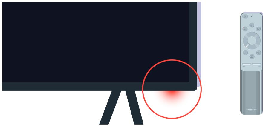
Vēlreiz pārbaudiet tālvadības pulsts sensoru. Ja LED indikators ir ieslēgts, nospiediet tālvadības pulsts ieslēgšanas/izslēgšanas pogu, lai ieslēgtu televizoru.
