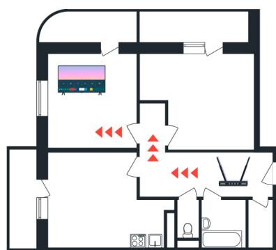
Ja izmantojat bezvadu piekļuves punktu, pārbaudiet piekļuves punkta atrašanās vietu. Ja piekļuves punkts no televizora atrodas pārāk tālu, pārvietojiet to tuvāk.
