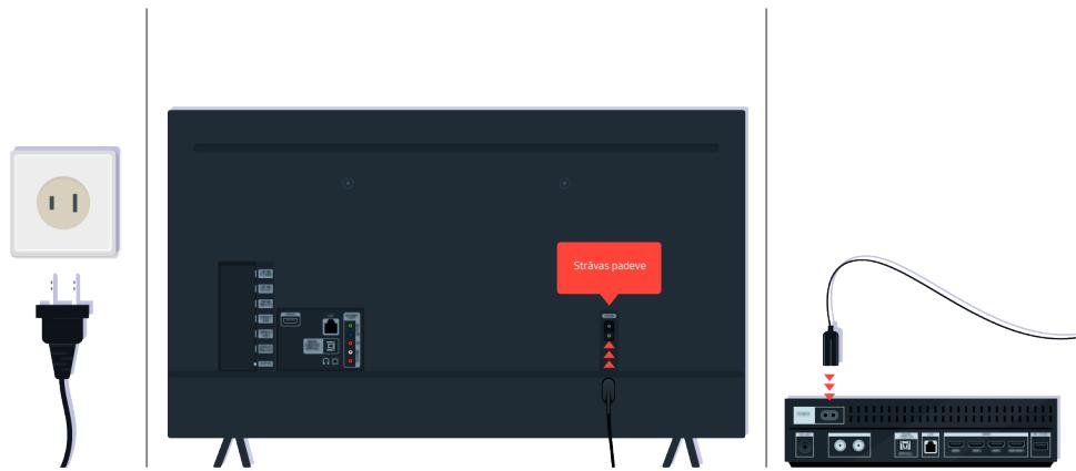
Ja tālvadības pults sensors nav ieslēgts, atvienojiet barošanas kabeli un iespraudiet to atpakaļ.
