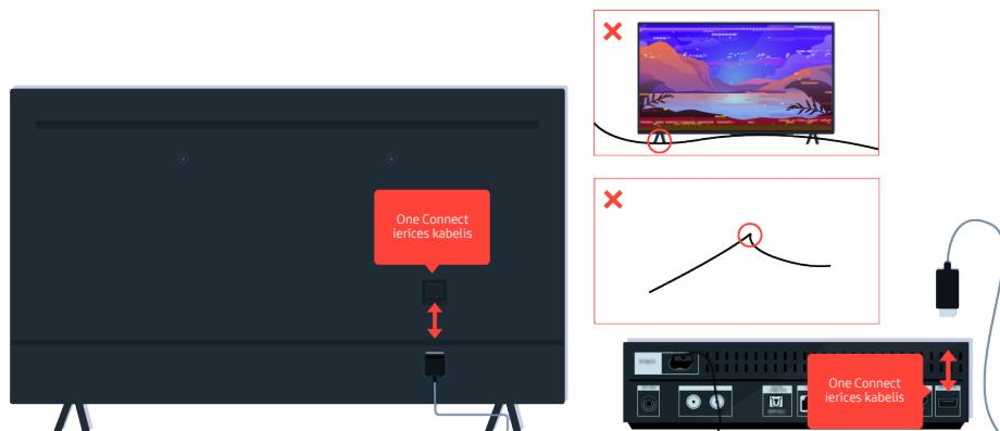
Ja problēma atkārtojas un ja jūsu televizoram tiek izmantots One Connect ierīces kabelis, atvienojiet un atkārtoti pievienojiet One Connect ierīces kabelis televizoram un One Connect (OC) blokam. Pārliecinieties, ka One Connect ierīces kabelis kabelis nav saspiests vai saliekts asā leņķī.
