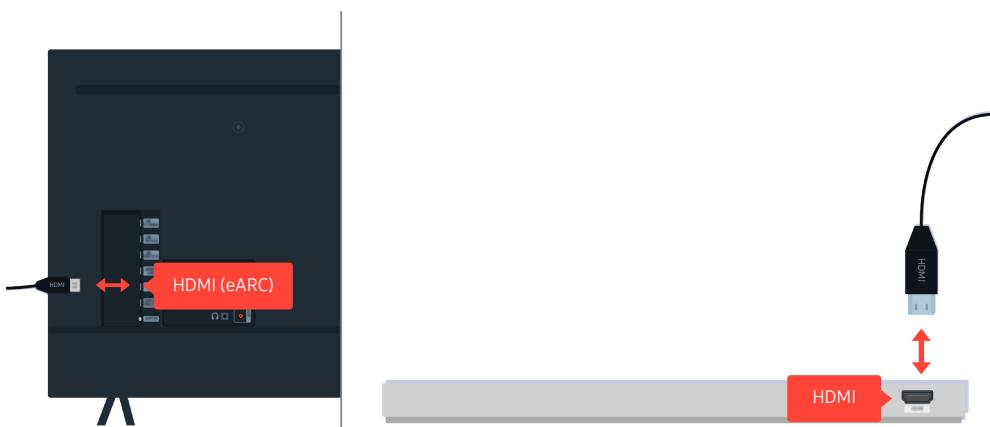
Ja skaņas konsole neatskaņo skaņu un tā ir savienota ar televizoru, izmantojot HDMI kabeli, pārbaudiet HDMI (eARC) savienotāju televizora aizmugurē.
