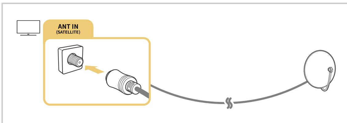
Ir ieteicams savienot abus savienotājus, izmantojot daudzfunkciju slēdzi vai DiSEqC slēdzi utt., kā arī iestatīt **Antenas savienojuma tips** uz **Divkāršs**.
