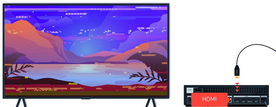
Ja ārējā ierīce atbalsta UHS video, izmantojet atvēlētu HDMI kabeli (4K) HDMI video atskānošanai.
