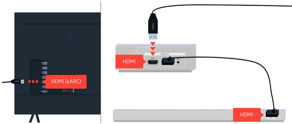
Ja ierīce Sound Bar ir savienota ar uztvērēju un uztvērējs ir savienots ar televizoru, izmantojot HDMI kabeli, pārbaudiet HDMI savienotāju televizora aizmugurē. Kabelim ir jābūt savienotam ar televizora HDMI (eARC) portu.
