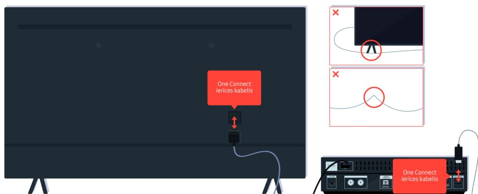
Atvienojiet un atkārtoti pievienojiet One Connect kabeli starp televizoru un One Connect (OC) bloku. Pārbaudiet, vai One Connect kabelis nav saspiests vai saliekts asā leņķī.
