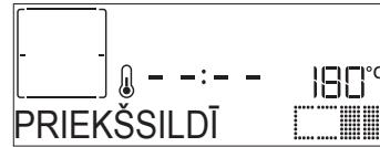
Kad šī fāze pabeigta, tiks atskanots skanas signāls un displejā parādīsies ziņojums, ka cepeškrāsns ir iesilusi līdz iestatītajai temperatūrai un jāievieto pārtikas produkti (norāde "PIEVENOJET"). Šajā brīdī ielieci pārtiku cepeškrāsnī, aizveriet durvis un sāciet gatavot.
