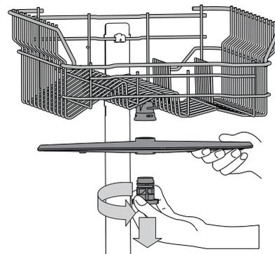
Lai noņemtu augšējo smidzināšanas sviru, pagrieziet plastmasas bloķēšanas gredzenu pretēji pulksteņa rādītāja virzienam. Augšējā smidzināšanas svira jānovieto tā, lai puse, kurā ir lielākais skaits caurumu, būtu vērsta augšup.
