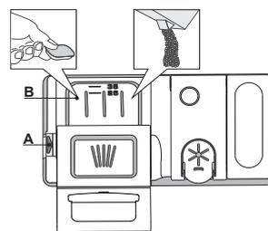
**Lai atvērtu mazgāšanas līdzekļa dozatoru, izmantojiet atvēršanas instrumentu A.**
