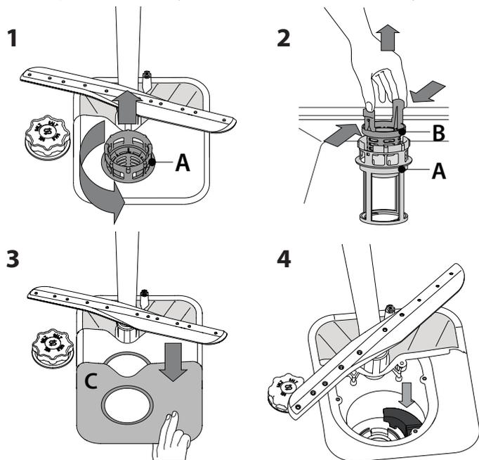
Pēc filtru iztīrīšanas novietojiet tos atpakaļ vietā un rūpīgi nostipriniet; tas ir svarīgi, lai saglabātu trauku mazgājamo mašīnas darbības efektivitāti.
