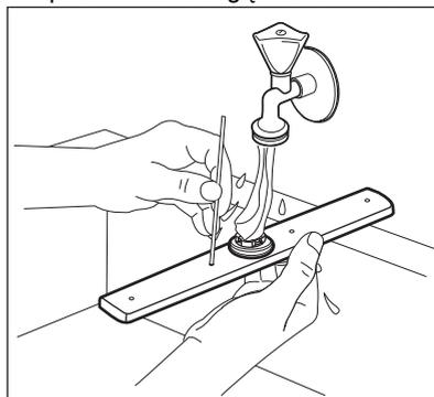
4. Norėdami vėl įdėti purkštovo alkūnę, įdėkite montavimo elementą į purkštovo alkūnę ir pritvirtinkite jį vamzdyje, pasukdami prieš laikrodžio rodyklę. Įsitikinkite, kad montavimo elementas užsifiksuotų savo vietoje.
