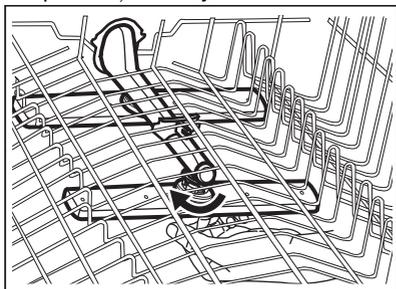
3. Nomazgājiet izsmidzinātāju zem tekoša ūdens. Lietojiet tievu, asu instrumentu, piem., zobu bakstāmo, lai izņemtu no atverēm netīrumus.
