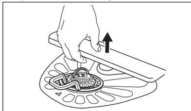
2. Nomazgājiet izsmidzinātāju zem tekoša ūdens. Lietojiet tievu, asu instrumentu, piem., zobu bakstāmo, lai iztīrītu no atverēm netīrumus.
