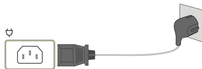
Lai izmantotu ierīci, pievienojiet barošanas kabeli ierīces pieslēgvietai un barošanas izvadam.
