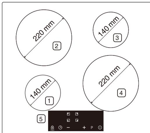
1. Indukciona zona za kvanje 1200 V sa povećanjem moći 1500 V
