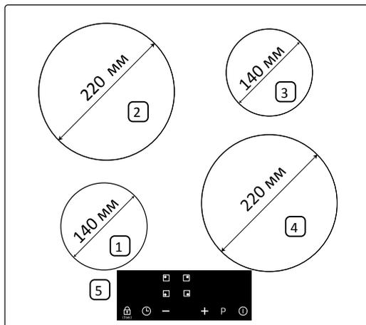
1. Индукционна нагревателна зона 1200 W с усилване на мощността 1500 W
